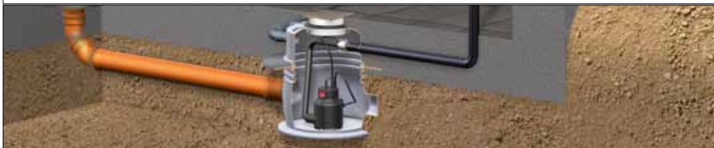
SINKAMAT-K avec siphon de sol intégré (n° art. 620442 + 620492).
