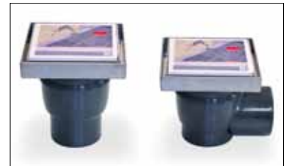
BLUESTONE siphon de sol en matière synthétique (PP) avec rehausse à carreler en inox AISI 304 et sortie verticale ou horizontale, classe A 15 kN (n° art. BIV001 / BIH002).
