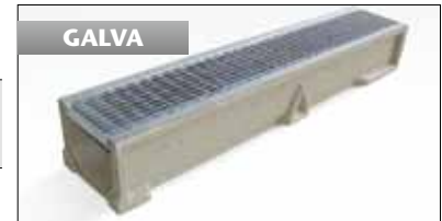
LARGE caniveau en béton polyester avec grille caillebotis en acier galvanisé, classe B 125 kN. Avec prémarque pour sortie ø 160 mm (n° art. 303612).
