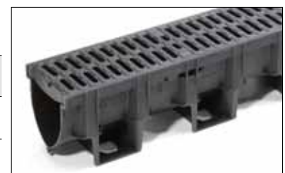
GALALINE caniveau avec 2 grilles passerelles intégrées classe B 125 kN (n° art. 11023).
