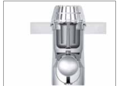
ALLROUND drainage avec coupe-odeur, crépine et élément anti-refouleur intégrés pour cour anglaise.
